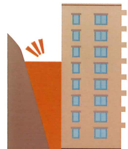
マンションと法面間の埋戻し
